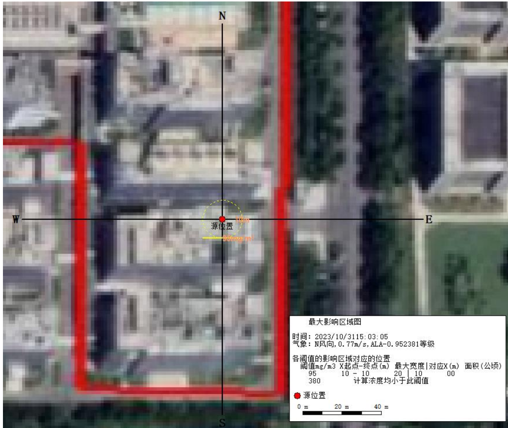
图 5.2-28 乙酸乙酯火灾事故发生后 CO 扩散结果示意图-常见气象
